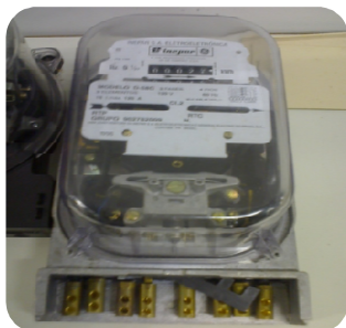
Medidor eletromecânico de energia elétrica Portaria n.º 285/2008
